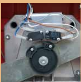
Tres micros interruptores garantizan precisión en los movimientos y cierres fiables
